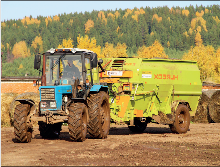
Умная машина «Хозяин» – «два в одном»: кормосмеситель и кормораздатчик
