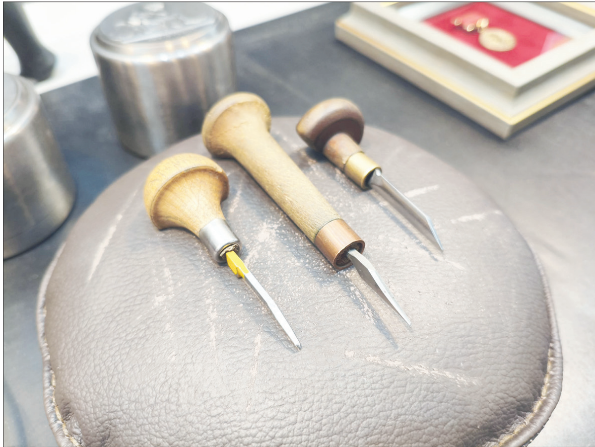
Штихели, несмотря на свой невзрачный вид – не менее важный инструмент, чем любая хитроумная, напичканная электроникой машина. И сегодня, несмотря на то что гравировка выполняется с помощью лазера и пневматики, в труде гравера остается элемент ручной работы. Фото предоставлено Краснокамским краеведческим музеем
