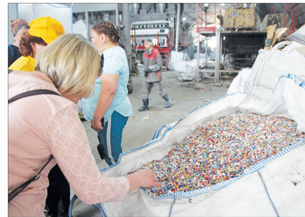
Из нескольких тюков бутылок получился один контейнер «конфетти». Это уже полуфабрикат: всё промыто, очищено и можно использовать для производства новых изделий.
