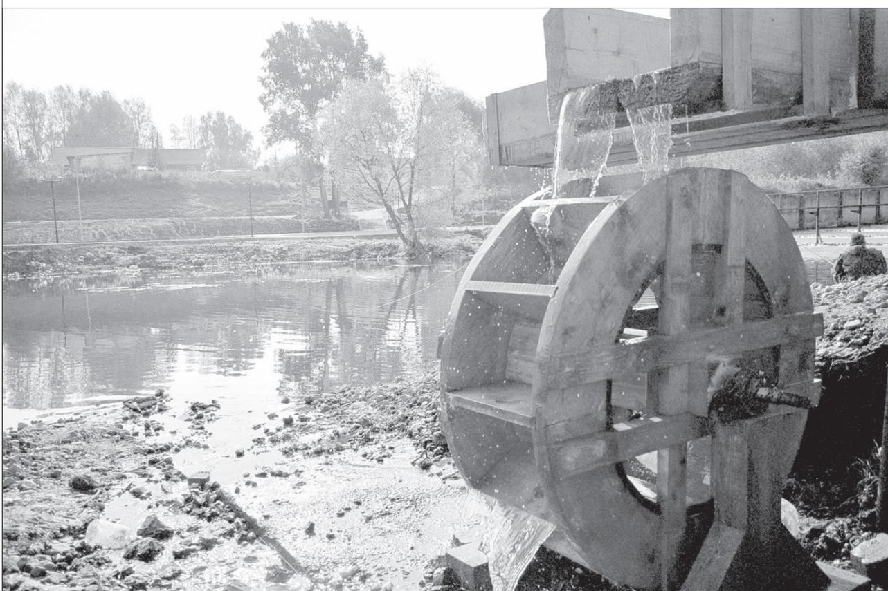
Водяное колесо - копия настоящего, только в меньших размерах. Того самого, что применялись в Ашапе два века назад, чтобы получить энергию, раздувающую меха горна для плавки медного песчаника. ФОТО: ИРИНА ТОЛШМАКОВА
