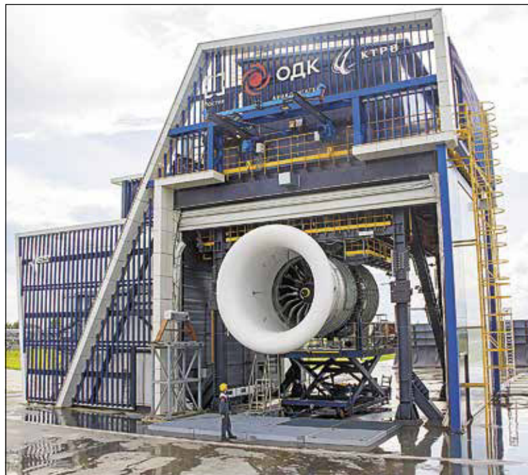
Испытания ДДТ ПД-35 на ОС-5
